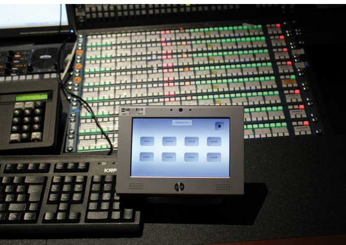
Il Pannello Cue a 8 pulsanti, in sala di regia, dal quale vengono gestiti gli scenari dei Ledwall.
